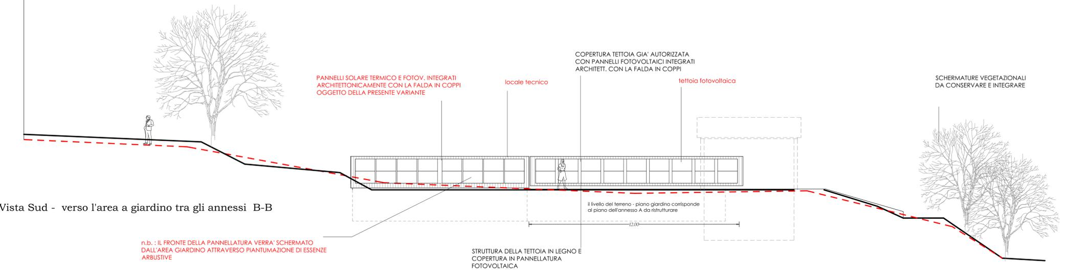
STRUTTURA DELLA TETTOIA IN LEGNO E COPERTURA IN PANNELLATURA FOTOVOLTAICA
