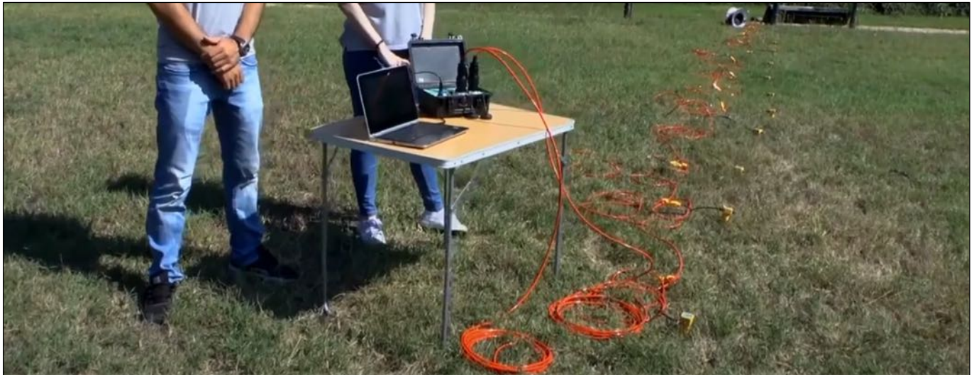
Figura 1. Configurazione strumentazione per acquisizione con sismografo GEA24.
