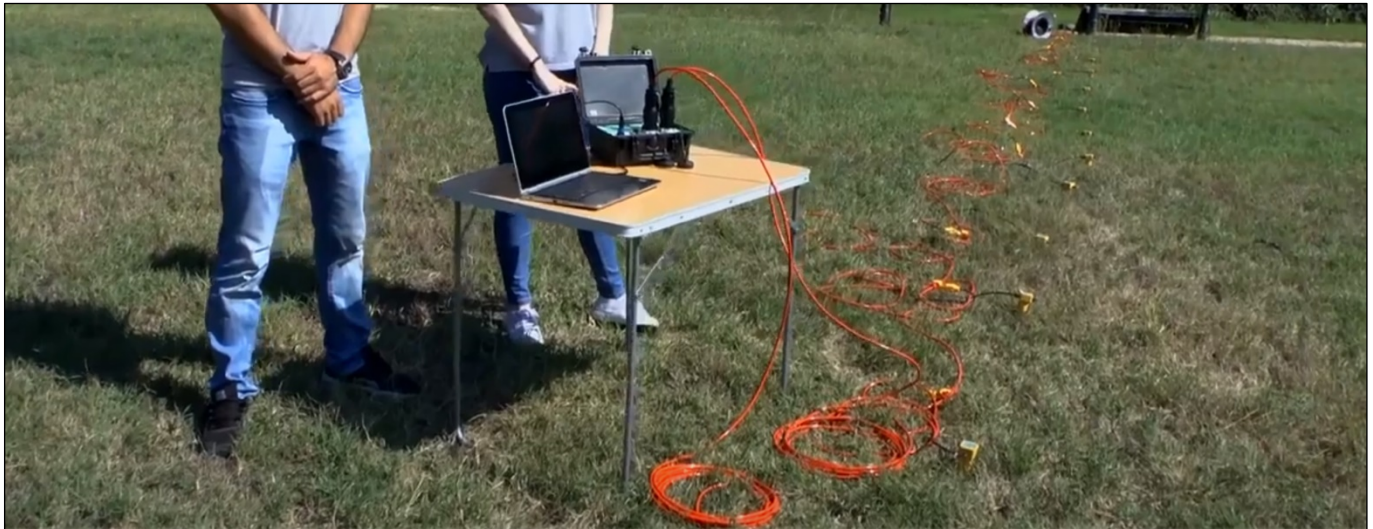
Figura 1. Configurazione strumentazione per acquisizione con sismografo GEA24.
